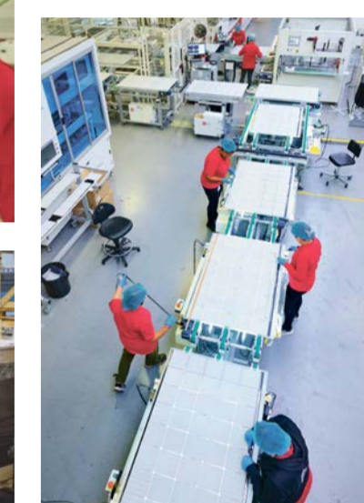
Hightech in der Werkhalle: Hier werden neuartige, gebäudeintegrierte Photovoltaikanlagen produziert.
